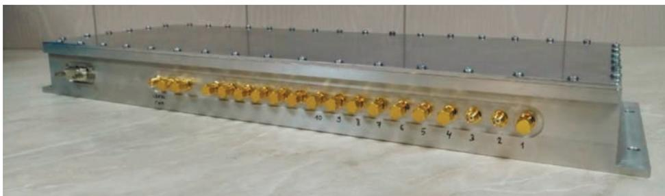
Рис. 2. Электронный блок системы синхронизации СААР из  $2 \times 2$  и  $3 \times 3$  элементов.
