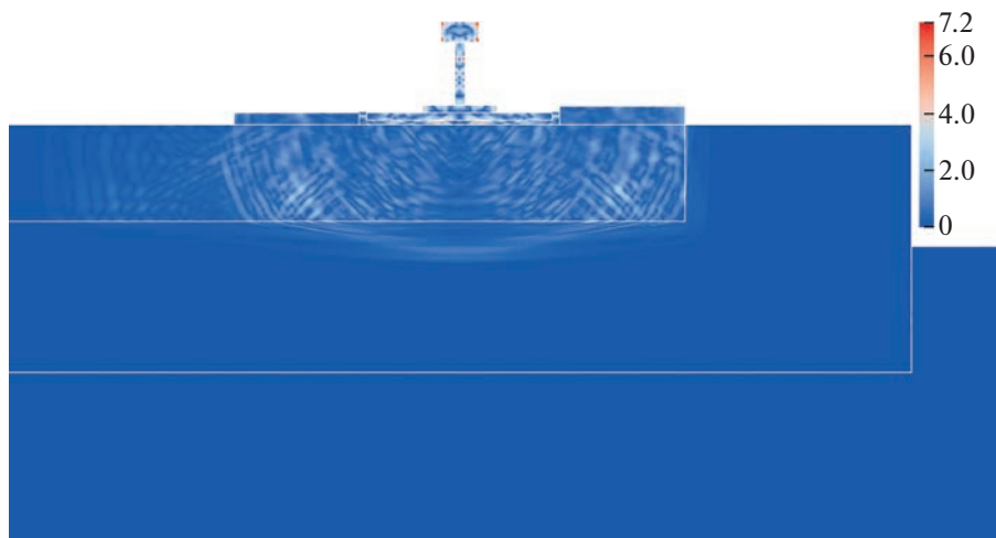
Рис. 3. Распространение волнового фронта по конструкции мостового полотна с балластом в момент времени 24 \times 10^{-5} с.
